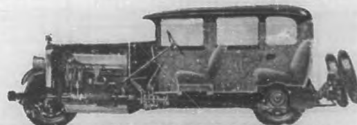
En un chasis moderno como éste, el piso inferior no dista más que veinte centímetros del suelo.
